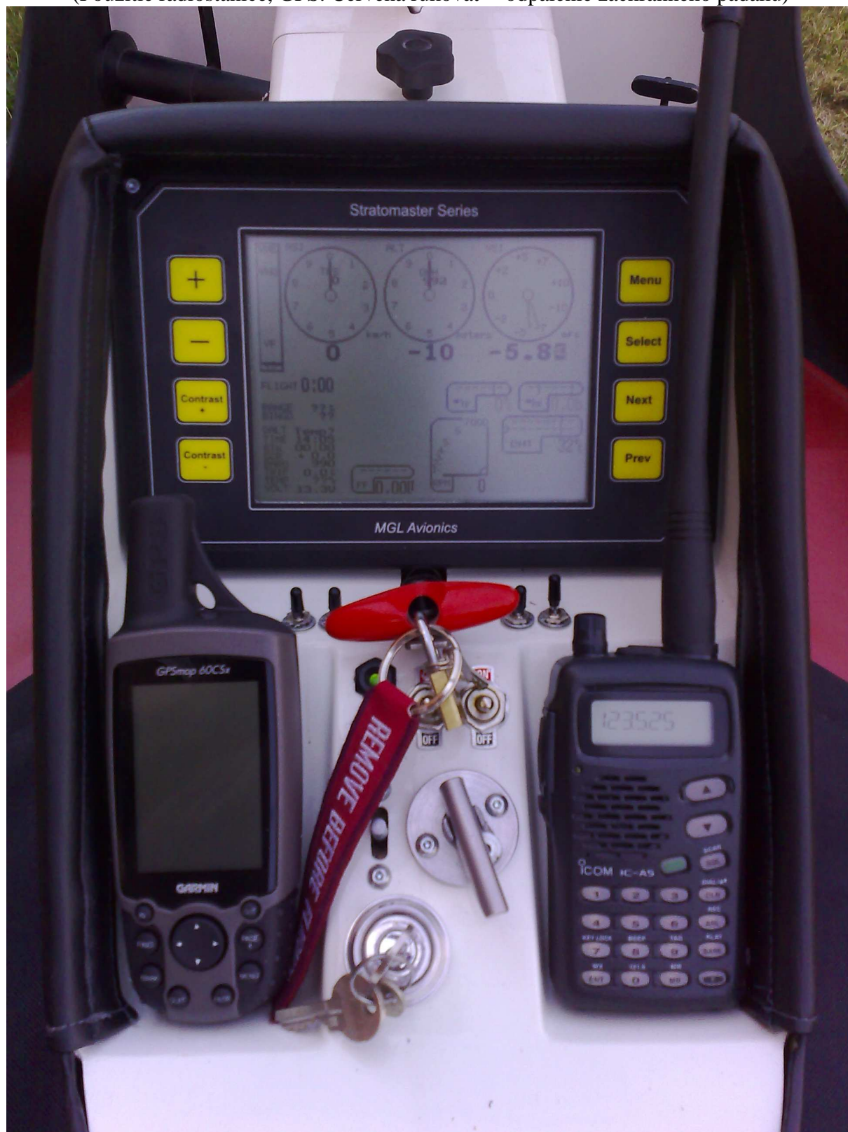
FOTO ZDRUŽENÉHO DIGITÁLNEHO PRÍSTROJA (Použitie rádiostanice, GPS. Červená rukoväť – odpálenie záchraného padáku)
