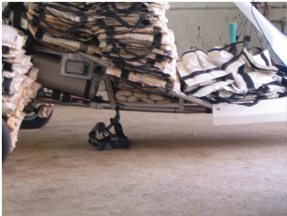
FOTO ZO STATICKÝCH PEVNOSTNÝCH SKÚŠOK DULV (Nemecko)
