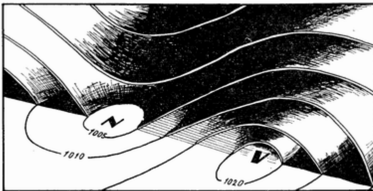
Obr. 1 Izobary jako průsečnice izobarických ploch se zemským povrchem
