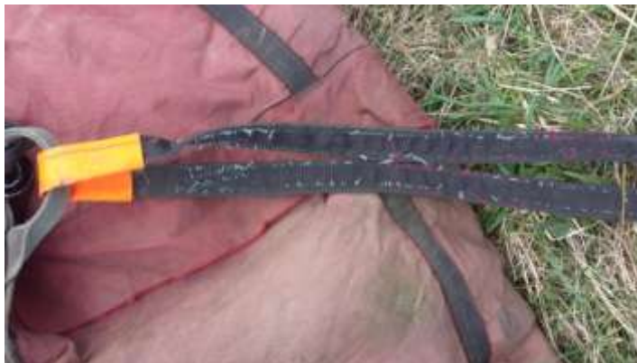
Detail rozpáraného popruhu prevlečeného do oka postroja
