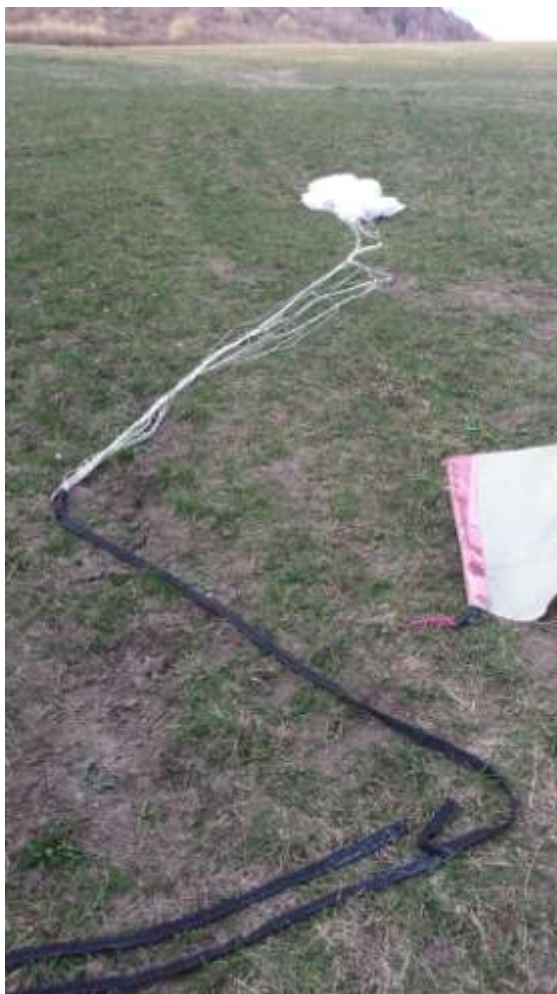
Záber na záložný padák a rozpáraný popruh záložného padáku
