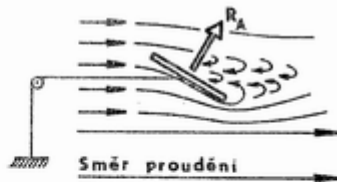
Obr. 11 Směr a smysl působení výsledné aerodynamické síly na kruhovou desku postavenou šikmo ke směru proudění; R_A - výsledná aerodynamická síla
