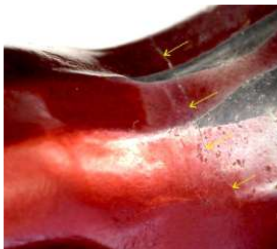
Začínajúci únavový lom na karabíne č.2 presne v tých istých miestach, kde sa inicioval rozvinul v prípade karabíny č.1.
