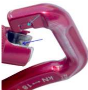
Foto č.2 Polodetail uzamykacej drážky a uzamykacieho výstupku
