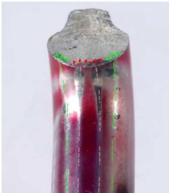
Priame polohové korešpondovanie medzi iniciačnými oblasťami lomu a pozdĺžnymi výstupkami na opornom pracovnom povrchu karabíny.
