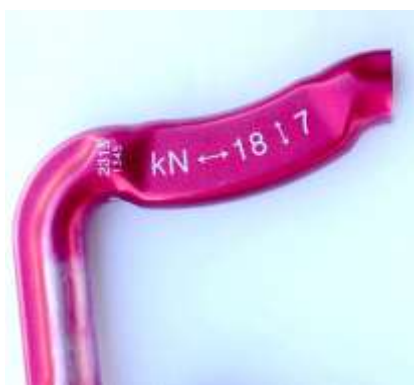
Výrobcom deklarovane statické nosnosti karabíny v pozdĺžnom a priečnom smere.
