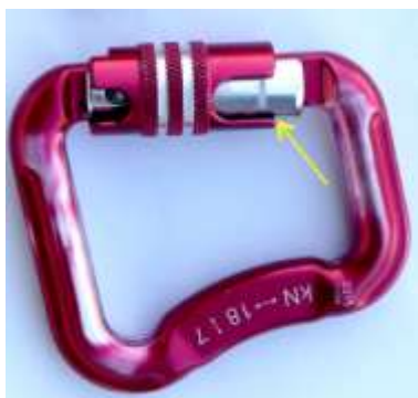
Foto č.1 Karabína predložená ako stopa č.2 a označená strana uzamykacieho mechanizmu, kde sa nachádzajú uvedené drážky a výstupky
