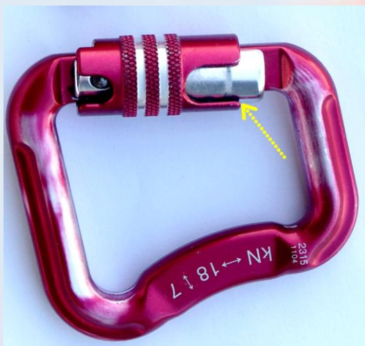
Foto č.8 Karabína predložená ako stopa č.2 a označená strana uzamykacieho mechanizmu, kde sa nachádzajú uvedené drážky a výstupky
