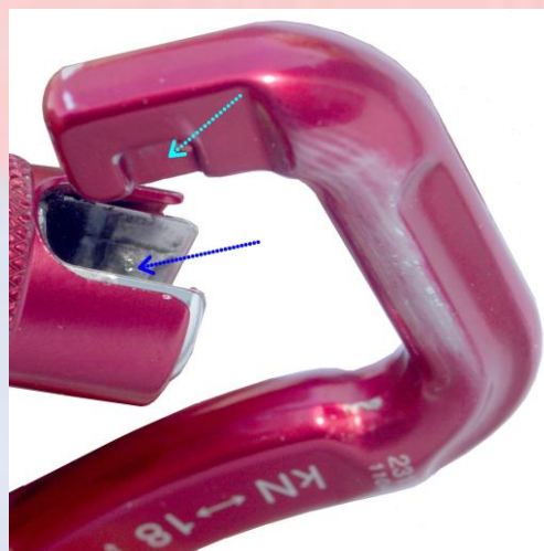
Foto č.9 Polodetail uzamykacej drážky a uzamykacieho výstupku
