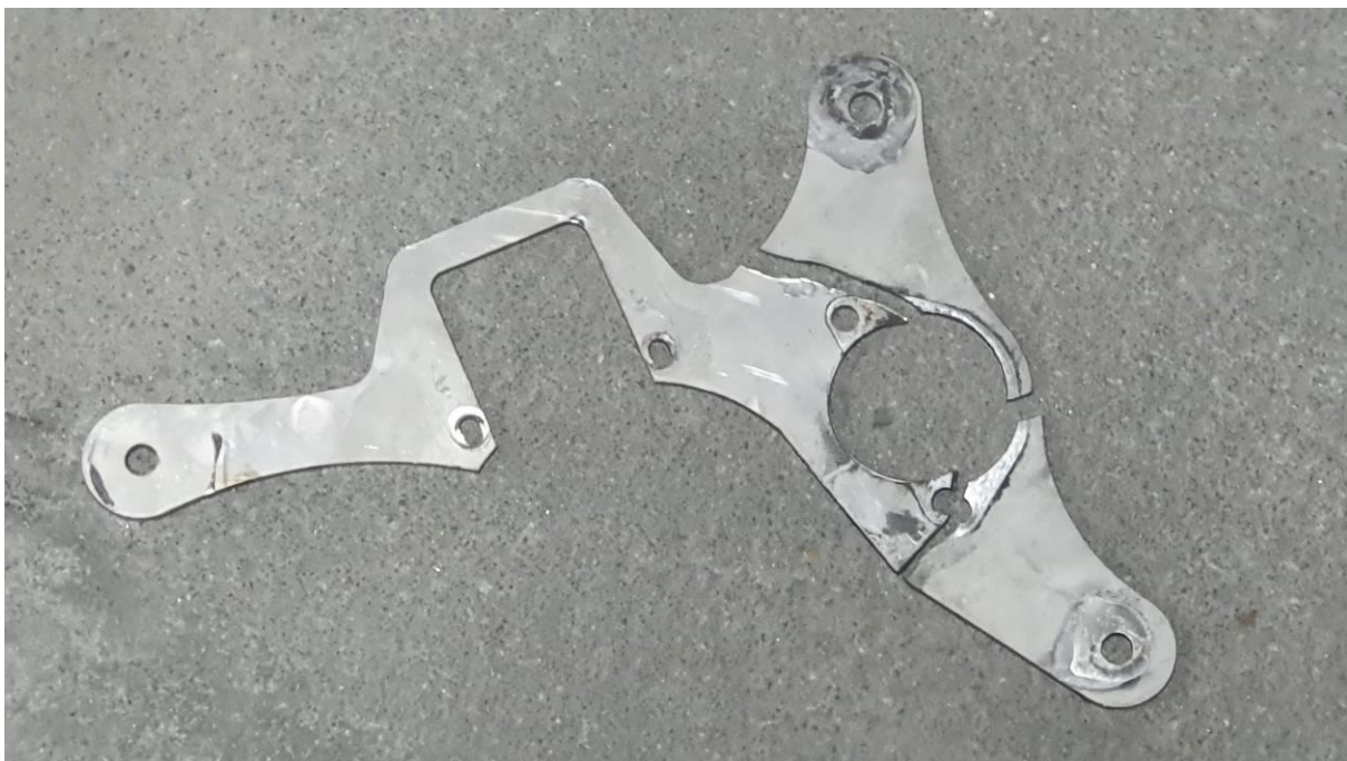
Poškodenie držiaku štartéra a cievky
