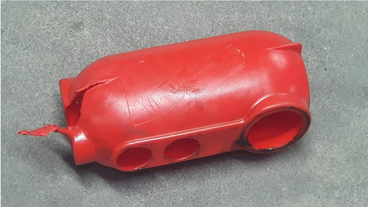
Obr. 3. Poškodenie tmiča nasávania
